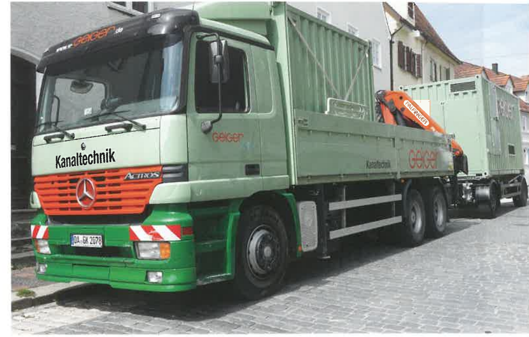
Lkw mit Magazin, Kran und Dampfanlage | Fotos: Geiger Unternehmensgruppe
